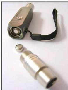
**Austausch der Batterien:** 3 x LR44 Batterien kommen im Zero 88 'Cable Test' zum Einsatz. Diese können nach dem Abschrauben der XLR 5 Pin female Seite getauscht werden. Achten Sie beim Zusammenbau auf die richtige Polarität der Batterien!
