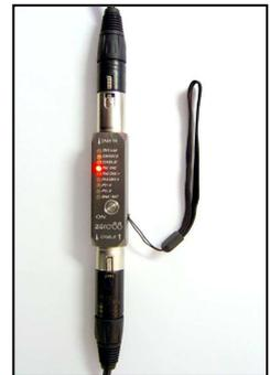
**Kabeltests bei bereits installierten DMX-Kabeln:** Mit Hilfe von zwei Zero 88 'Cable Test' Geräten können sogar bereits installierte DMX-Kabel überprüft werden. Stecken Sie einen 'Cable Test' an jede Seite des Kabels (für eine Seite wird ein female/female Adapter benötigt) und aktivieren Sie den Kabeltest-Mode. Der Kabeltest verläuft nun zwischen den beiden DMX-Testgeräten und lokalisiert mögliche Probleme bei dem installierten DMX-Kabel.
